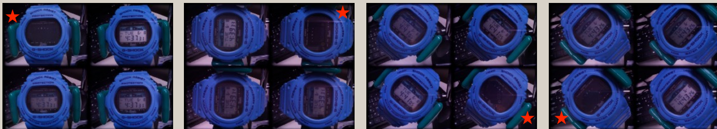
マルチ偏光複眼カメラPiTOMBO-HQ(MPL)による撮影例：腕時計の液晶表示が特定★個眼で消失している
